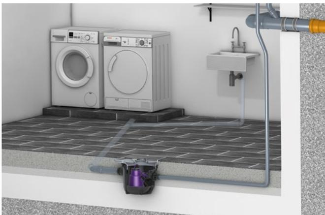
La stazione di sollevamento per l'impiego domestico *Minilift S* trova posto facilmente sotto qualsiasi lavabo o anche nel pavimento della cantina. Possono essere collegate senza problemi una lavatrice, una doccia o delle ulteriori entrate. L'impianto è dotato di una pompa da 300 watt con commutazione a galleggiante.
