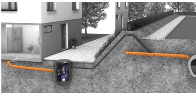
Ideale per lo smaltimento delle acque di scarico contenenti sostanze fecali. Installabile sia in appoggio che interrata, la stazione di pompaggio *Aqualift F Basic* è la soluzione più semplice e conveniente. Offre la tecnica più moderna inserita in un robusto pozzetto di installazione.
