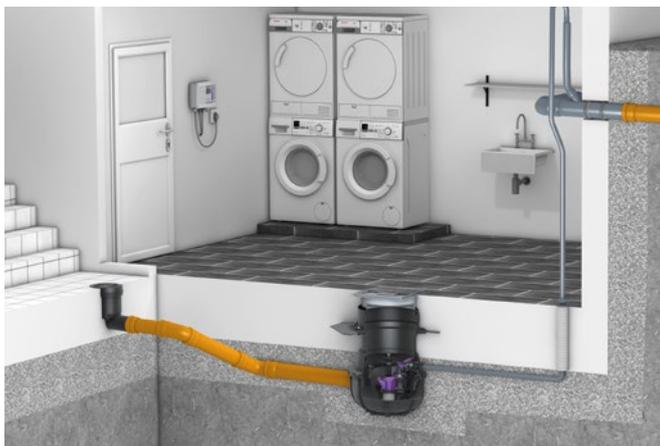
La stazione di sollevamento *Aqualift S Compact* smaltisce in modo affidabile e igienico tramite un condotto di mandata le acque di scarico non contenenti sostanze fecali nella canalizzazione. È disponibile sia con comando a galleggiante, che con comando a sonda. Il rialzo regolabile in altezza, inclinabile e girevole consente la regolazione dell'altezza durante l'installazione e l'adeguamento al reticolo delle piastrelle.
