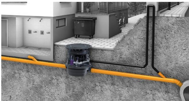
Con *Ecolift XL* offriamo un impianto di sollevamento ibrido, specialmente per l'impiego negli edifici a uso commerciale e nelle case plurifamiliari con pendenza naturale verso la canalizzazione. *Ecolift XL*, nel funzionamento normale sfrutta la pendenza naturale e pompa le acque di scarico solo in caso di riflusso – con potenze della pompa da 1,5 a 4,5 Kilowatt.
