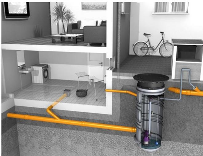
La stazione di pompaggio *Aqualift S* è utilizzabile per lo smaltimento delle acque di scarico non contenenti sostanze fecali al di sotto del livello di riflusso, per la sicurezza anti-ristagno degli impianti separatori e per il prosciugamento dei condotti di drenaggio. È composta da un pozzetto standard Ø 600 e da una pompa integrata per le acque grigie e piovane ed è resistente all'acqua freatica fino a 2500 mm.
