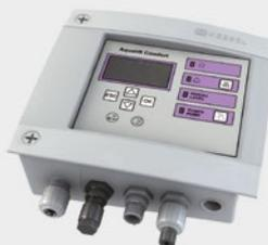
Controlla ogni mese automaticamente il funzionamento di pompa e sonda. In caso di disturbo di funzionamento o di installazione inappropriata, l'apparecchio emette un avviso. Con display, sistema di auto-diagnostica (SDS) integrato e bufferizzazione della batteria. Adatto per la rilevazione del livello pneumatica, le sonde conducimetriche e gli interruttori a galleggiante. Pronto per il collegamento tramite il connettore codificato.
